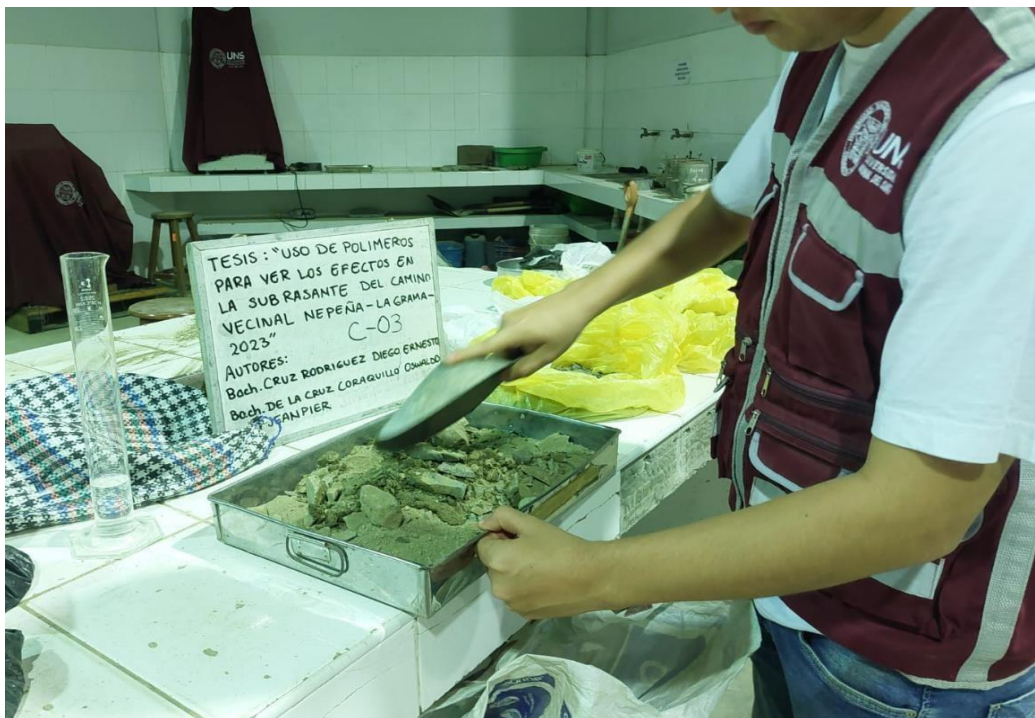
Figura 21 Ensayo para determinar los límites de consistencia de las muestras de suelos de la C-03
