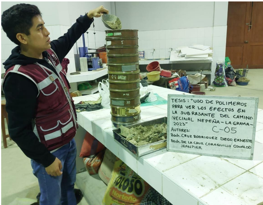
Figura 22 Ensayo para determinar la granulometría de las muestras de suelos de la calicata 05
