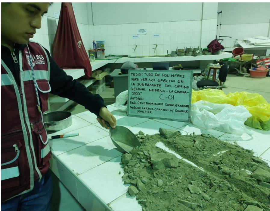
Figura 19 Cuarteo de las muestras de suelos de la calicata 01
