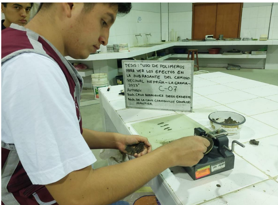
Figura 23 Ensayo para determinar los límites de consistencia de las muestras de suelos de la calicata 07
