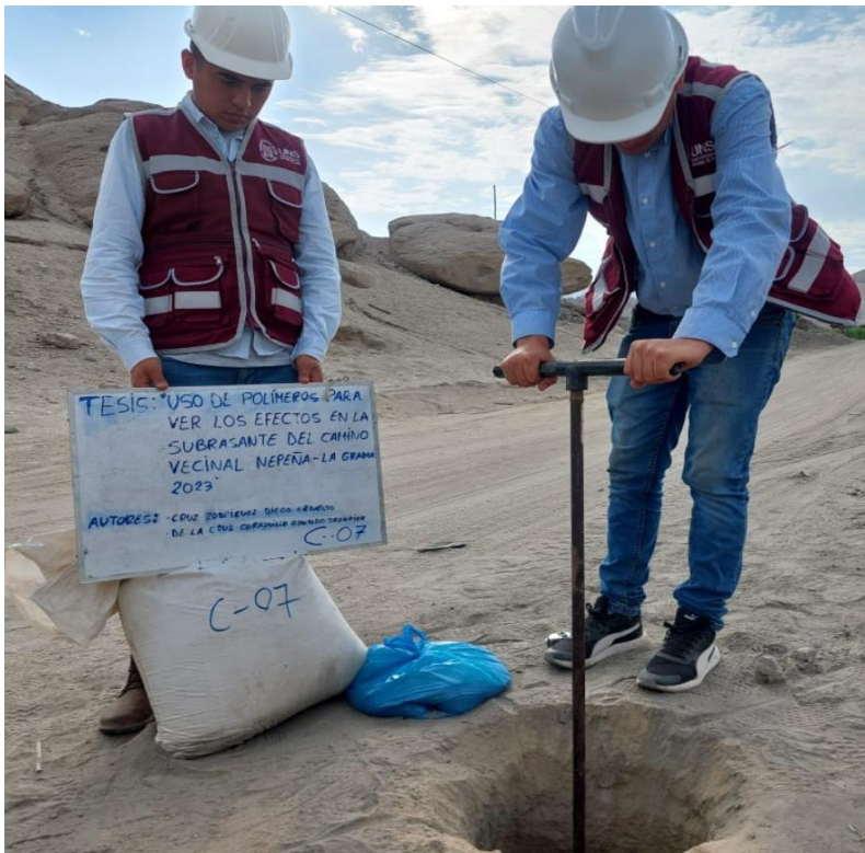
Figura 16 Excavación y obtención de muestras de suelo de la calicata 07
