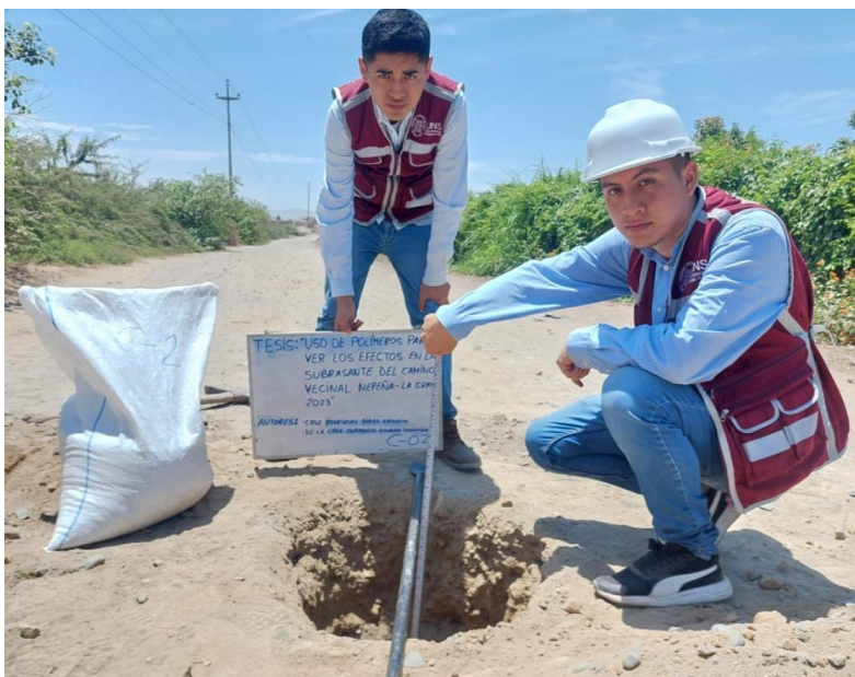
Figura 11 Excavación y obtención de muestras de suelo de la calicata 02
