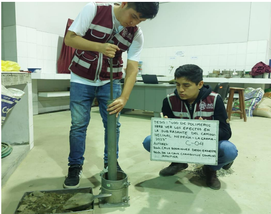
Figura 24 Ensayo para determinar la máxima densidad seca y humedad óptima de las muestras de suelos de la calicata 04
