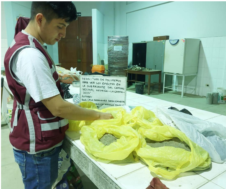
Figura 18 Selección de las muestras de suelos de la calicata 01
