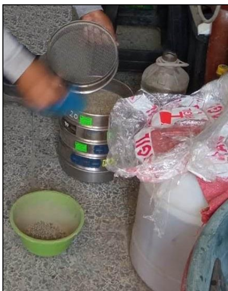
Fotografía 4. Análisis granulométrico arena gruesa
