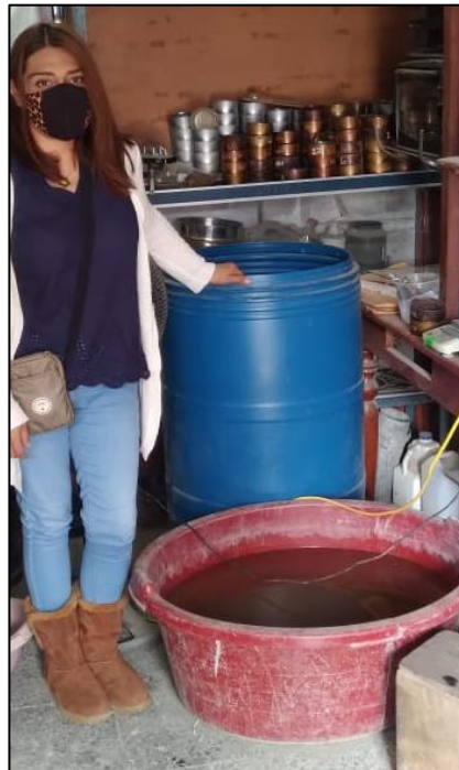
Fotografía 14. Cilindro para curado de muestras de concreto reciclado y natural
