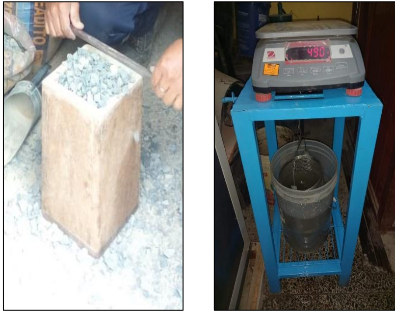
Fotografía 7. Peso específico del agregado grueso
