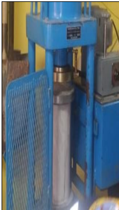
Fotografía 21. Rotura de espécimen concreto 0%-R a los 14 días de curado
