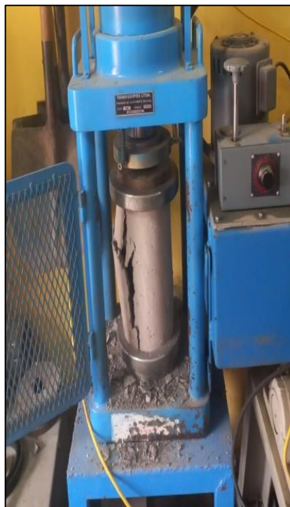
Fotografía 23. Rotura de espécimen 50%-R a los 7 días de curado
