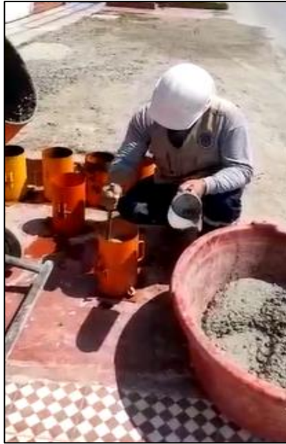
Fotografía 13. Colocado de mezcla en 3 capas con una varilla 5/8" y apisonado 25 veces en cada capa según NTP 339.183.2013
