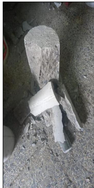
Fotografía 23. Rotura de espécimen 50%-R a los 7 días de curado
