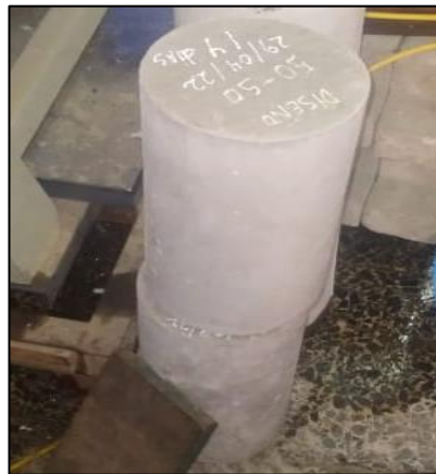
Fotografía 18. Muestras a los 14 días de curado concreto natural
