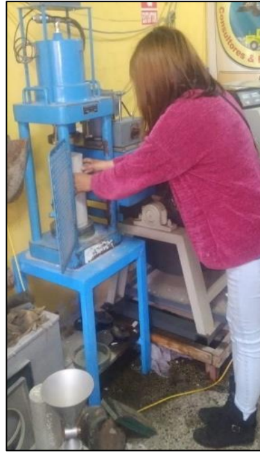
Fotografía 20. Rotura de especímenes de concreto
