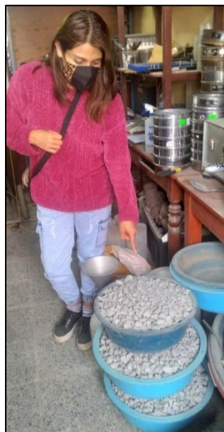
Fotografía 3. Agregados reciclados provenientes de especímenes de probetas de concreto f'c 210 kg/cm 2
