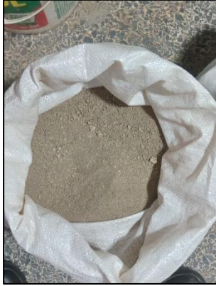
Fotografía 1. Arena gruesa Zarandeada procedente de Cantera Estrella de Belén (Huarmey)
