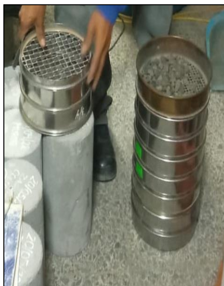
Fotografía 5. Análisis granulométrico del agregado grueso natural
