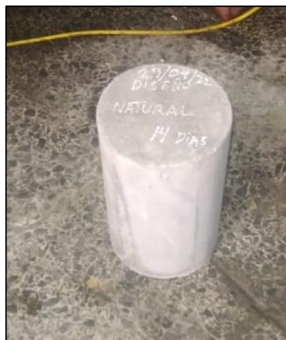
Fotografía 19. Muestras a los 14 días de curado 50%-R Ag. grueso
