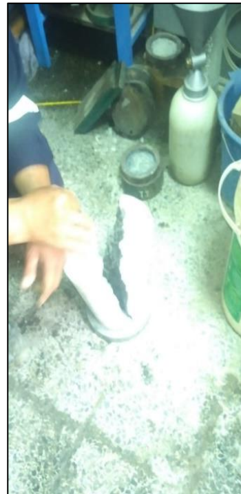
Fotografía 21. Rotura de espécimen concreto 0%-R a los 14 días de curado
