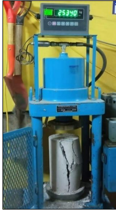
Fotografía 22. Rotura de espécimen de concreto 0%-R a los 28 días
