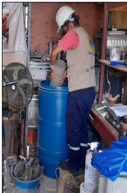
Fotografía 16. Colocación de especímenes de concreto en cilindro
