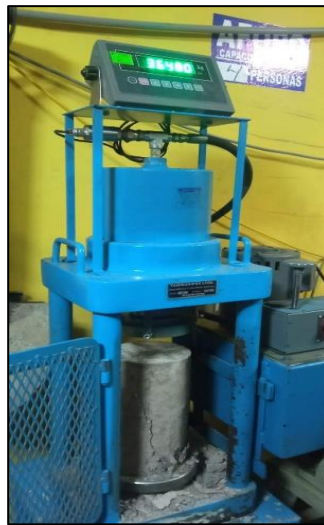
Gráfico 9. Máquina automática de ensayos de compresión para rotura de concreto
