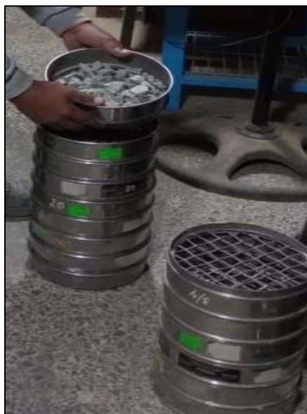
Fotografía 6. Análisis granulométrico del agregado reciclado
