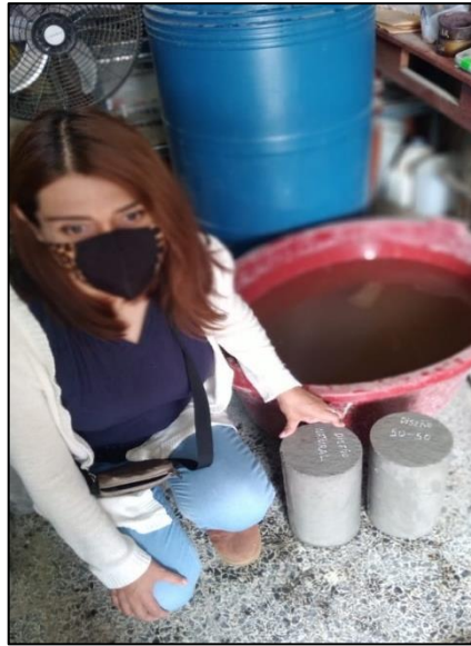
Fotografía 17. Especímenes para rotura a los 7 días.
