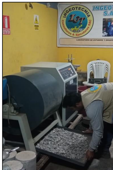
Fotografía 8. Ensayo de desgaste en la Máquina de los Ángeles de los agregados reciclados
