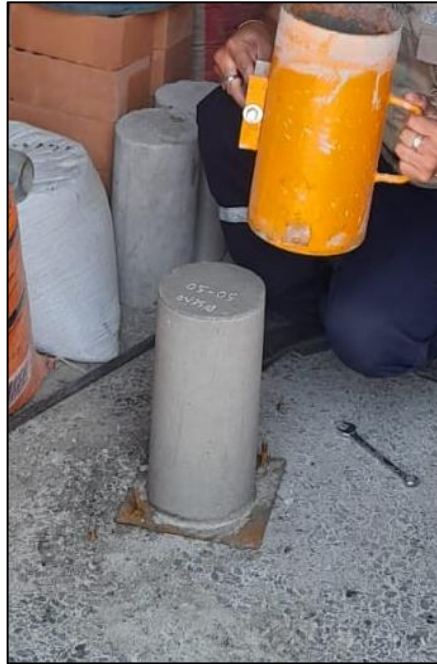
Fotografía 15. Desmoldado de especímenes de concreto
