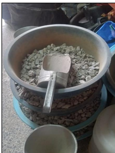
Gráfico 8. Muestra triturada de agregados reciclados
