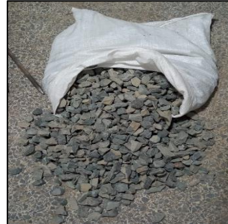
Fotografía 2. Agregado grueso ½” procedente de cantera Piedra Liza (Nepaña)
