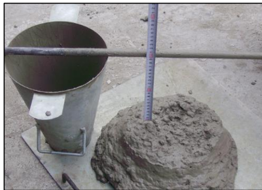
Gráfico 5. Toma de medida de slump con el cono de Abrams
