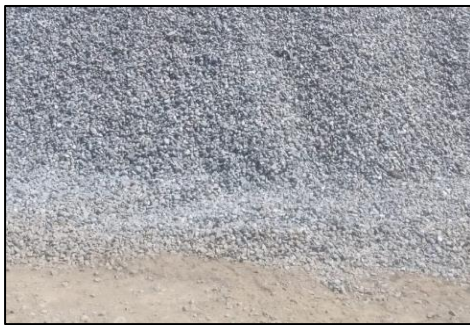
Fotografía 2. Agregado grueso ½” procedente de cantera Piedra Liza (Nepaña)
