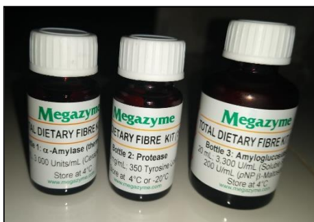
Fotografía 5.1: Enzimas utilizadas en la determinación de fibra dietética
