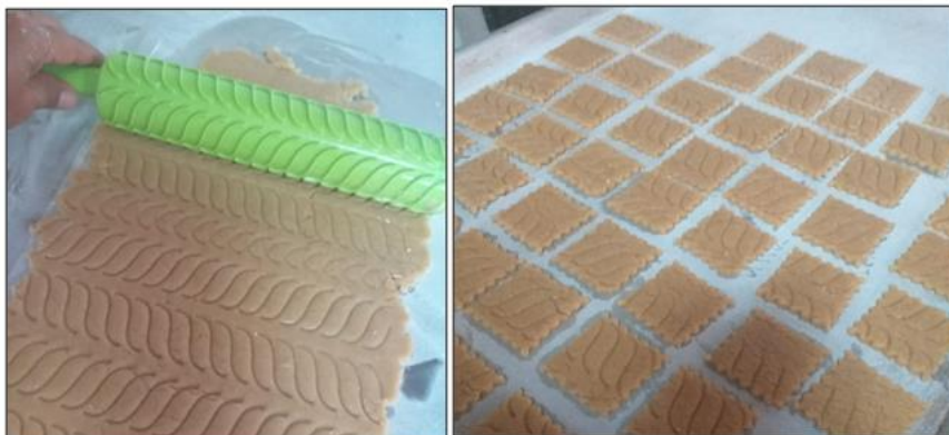
Fotografía 4.3: Laminado y troquelado de galletas fortificadas
