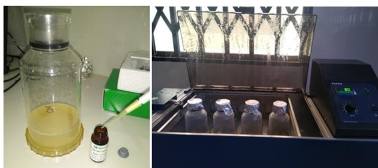
Fotografía 5.2: Incubación a 80°C de las muestras conteniendo \alpha -amilasa y buffer fosfato
