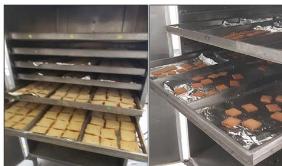
Figura 13: Deshidratado de pan de molde y galletas fortificadas en el secador de bandejas del IITA
