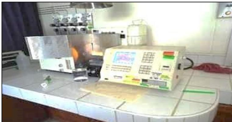
Figura 3. Espectrofotómetro de absorción atómica marca Buck Scientific.
