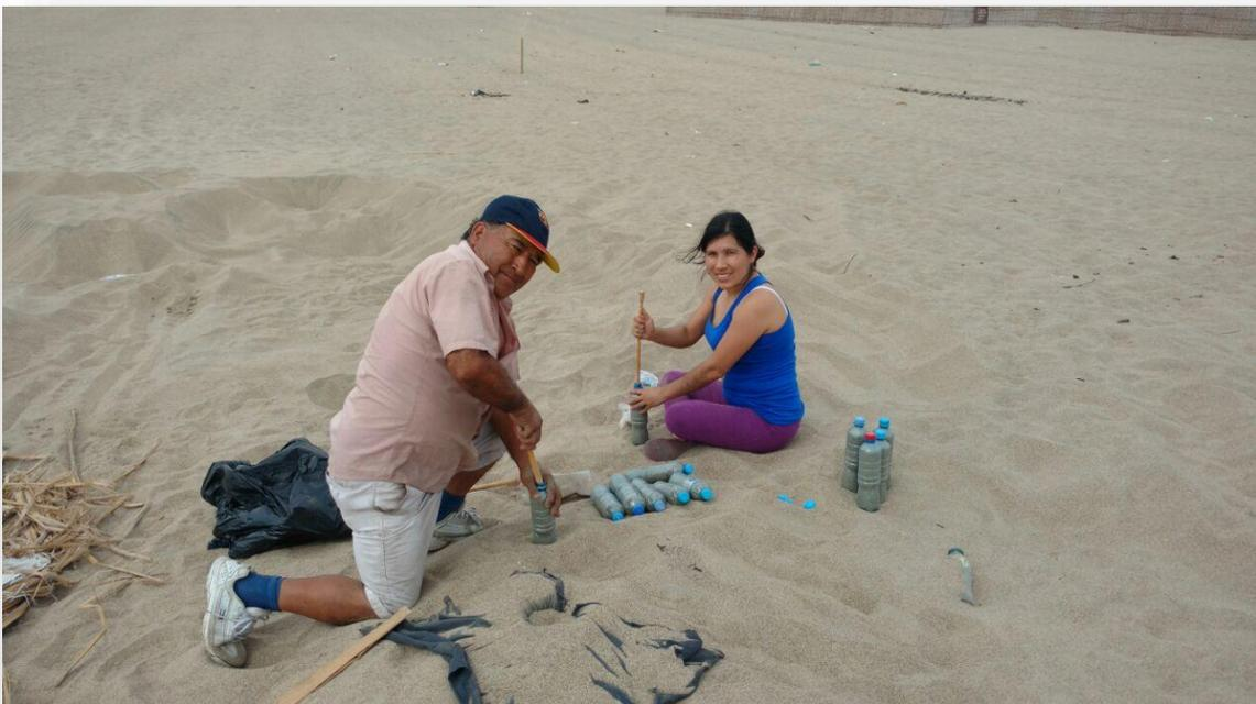
Figura 04: Elaboración de los Ladrillos Tipo PET, con material de relleno de la zona de expansión.
