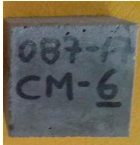
Figura 17: Ensayo de resistencia a la compresión de los cubos de mortero de pega, a los 14 días y 28 días..
