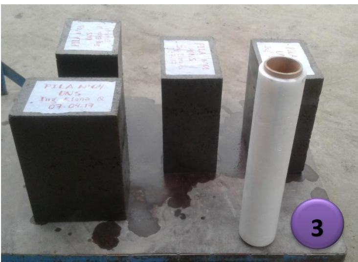
Figura 09: Colocación de Vinifill en los prismas, para la conservación de la humedad, en los mismos.
