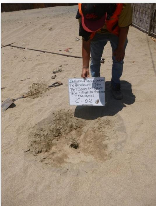
Figura 02: Ubicación de la Calicata N°02, para realizar los estudios de mecánica de suelos.
