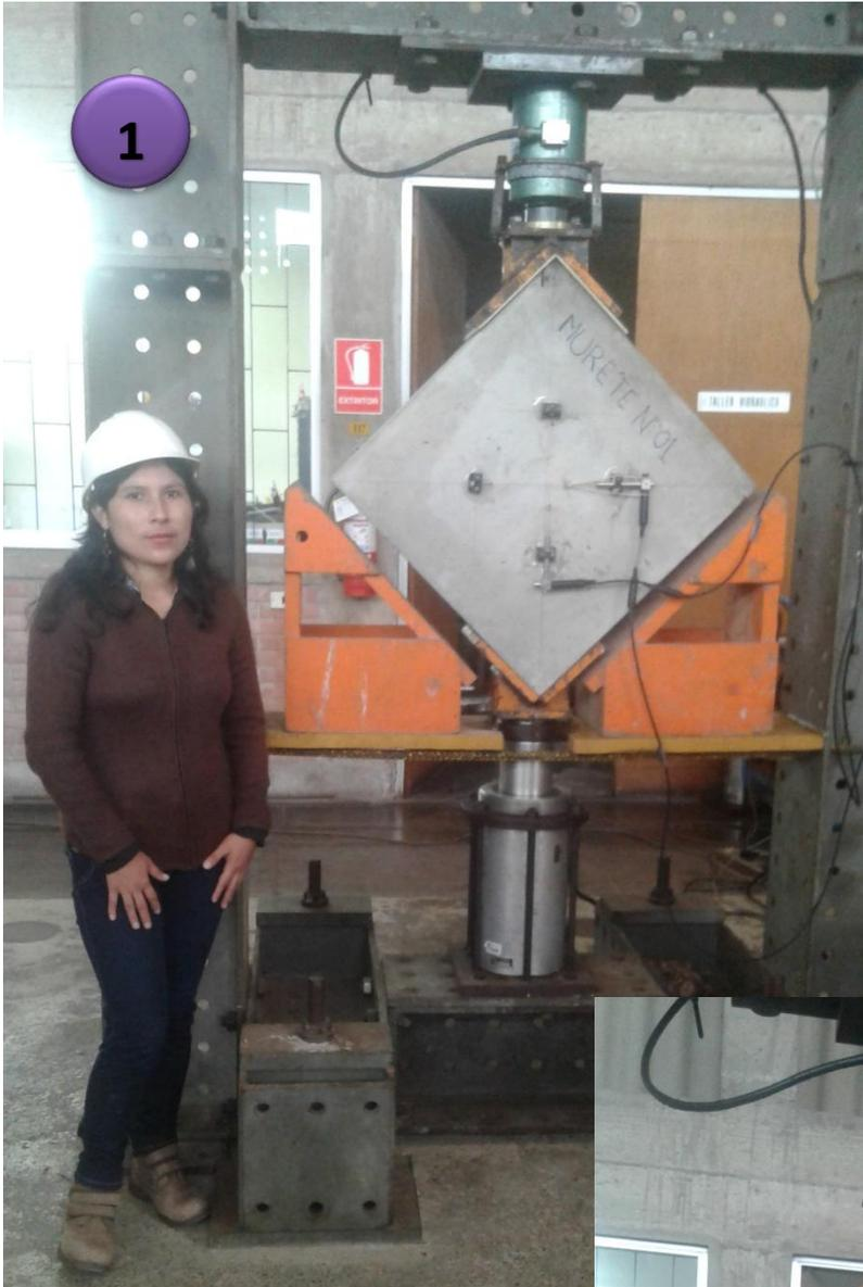
Figura 13: Ensayo de Tracción Diagonal por corte en los muretes tipo PET.
