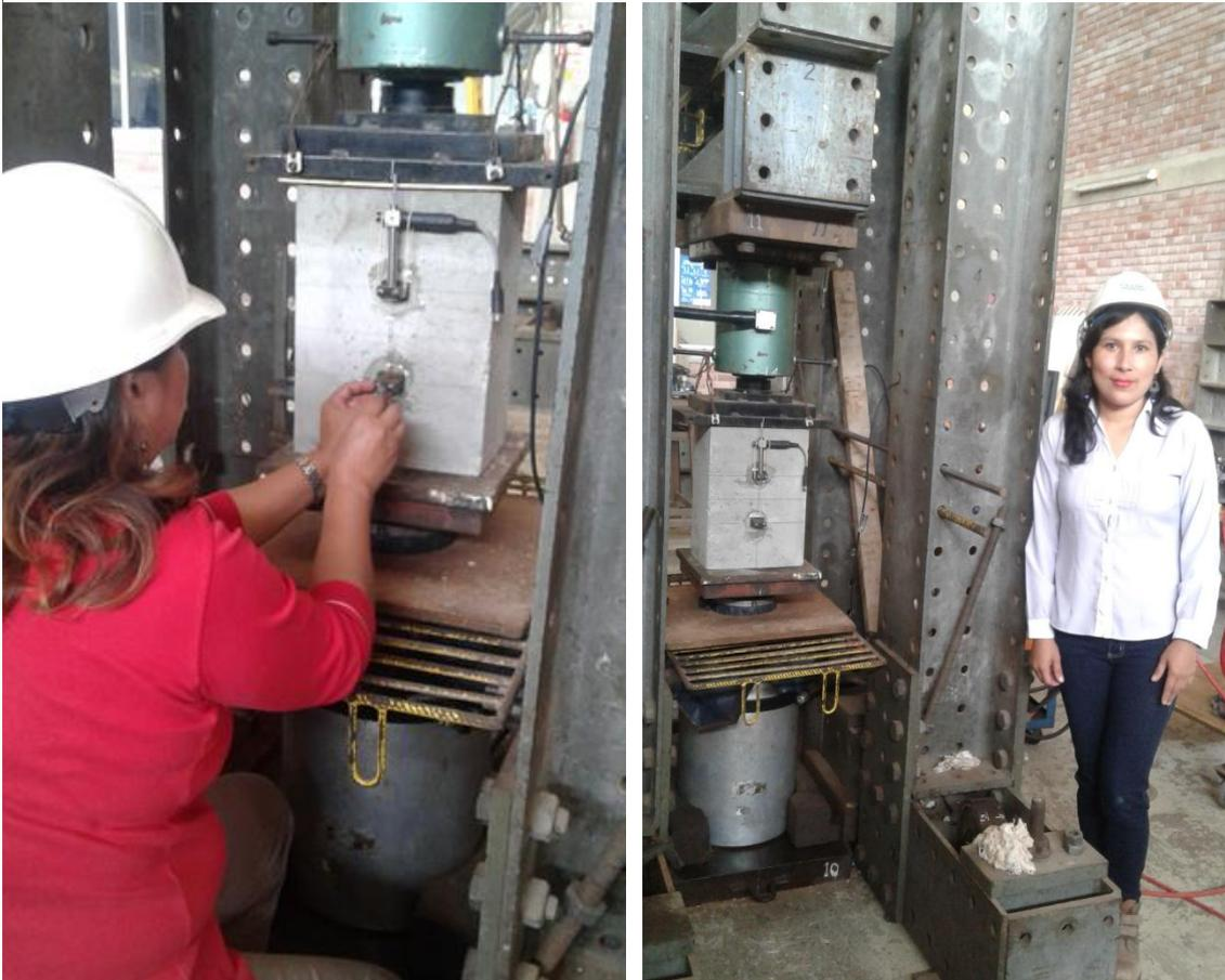
Figura 11: Ensayo de Resistencia a la Compresión de los Prismas tipo PET. Obsérvese las fallas mecánicas.
