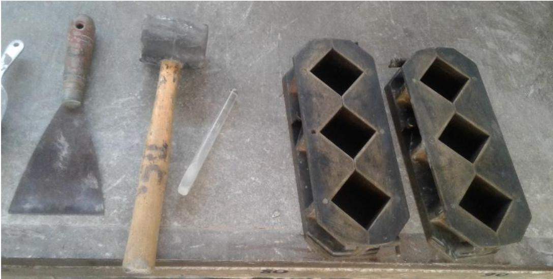
Figura 14: Herramientas para la elaboración de los cubos de mortero de pega.
