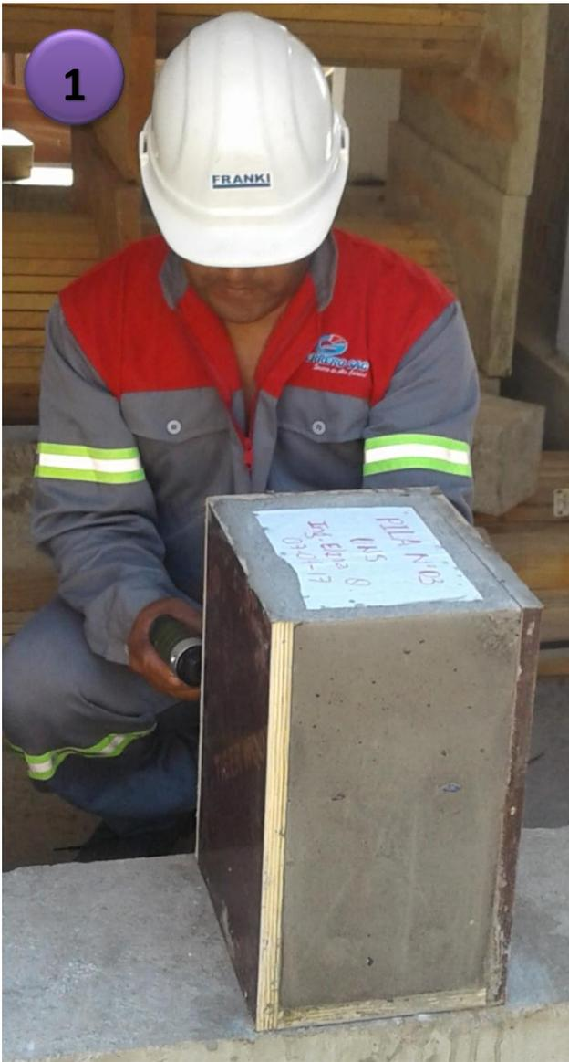
Figura 08: Desencofrado de Prismas a las 48 horas.
